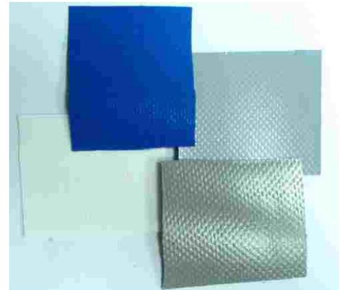
Plane aus geflochtenem PVC für Außenhaut aus höchster Qualität, antistatisch behandelt, schwer entflammbar, 550/600 gr Kettendichte pro Quadratmeter. Weißt hohe Reiß- und Weiterreißfestigkeit auf, Reinigungs- und wartungsfreundlich. Elektrostatischbehandelt.
