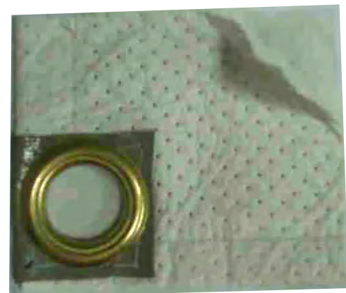
HDPE/PP/HDPE trilaminado, microperforado, el corazón del multibag. Material de triple capa, con efecto amortiguador, especialmente concebido para embalajes, proporciona una excelente protección frente a superficies plásticas y textiles, sin provocar abrasiones ni brillos. La confección de los hoyados está reforzada con PVC para evitar desgarros, dobladillos con doble cosido, la mejor confección para el mejor material. Tratamiento electroestático según EN 1149-1
